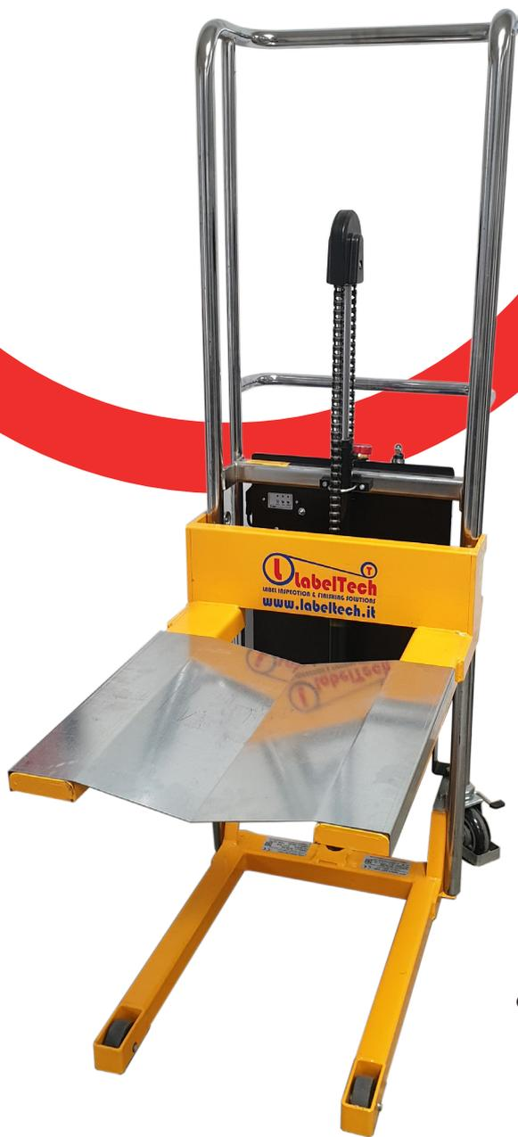
Elevatore manuale compatto e maneggevole dotato di sollevamento con pompa idraulica a pedale (o elettroidraulica) e ruote in poliuretano di grande diametro per una elevata scorrevolezza (due fisse e due sterzanti complete di freno). Asportando il piano di carico il carrello si può utilizzare come elevatore a forche. Il pedale di sollevamento si può posizionare in verticale per ridurre l'ingombro e la discesa è controllata da una valvola con volantino.
